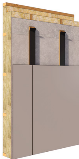
Konstruktion med lodret træskellet bagved vindplade.
