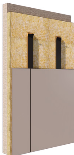
Konstruktion med afstandslister monteret på isolering og tung bagvæg.
