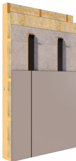
Konstruktion med vandret krydsforskalling bagved vindplade.
