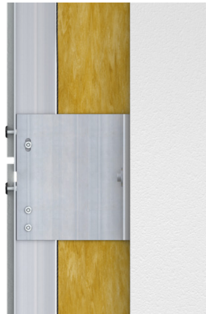
Skjult profilsamling i kombination med fastgørelse til aluminiumsvinkelbeslag
